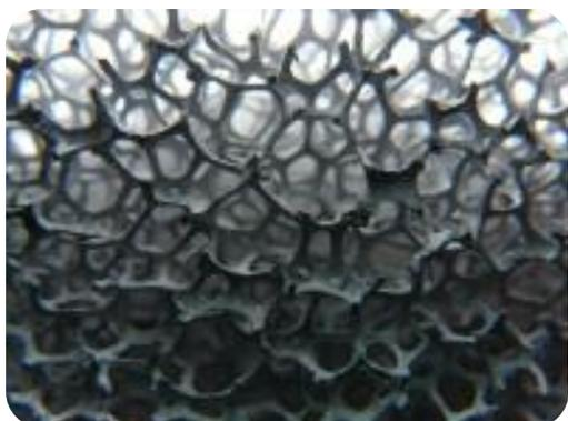
Катализатор ЭКАТ-ЭКО предназначен для глубокого окисления органических соединений до углекислого газа и воды. Катализатор ЭКАТ-ЭКО может быть применен как для существующих реакторов-утилизаторов, так и для проектируемых. Высокая надежность и уникальные свойства катализатора ЭКАТ-ЭКО, делают его незаменимым в области охраны окружающей среды на
