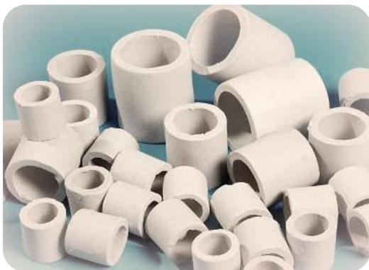
Катализатор верхнего слоя ТНК-2103 используется в реакторах гидроочистки средних и тяжелых нефтяных дистилляторов в дополнении к основному катализатору. Катализатор представляет собой активный оксид алюминия, сформованный в виде колец Рашига, содержащий добавки активных компонентов, способствующих предварительному гидрооблагораживанию сырья и препятствующих образованию коксоотложений.
