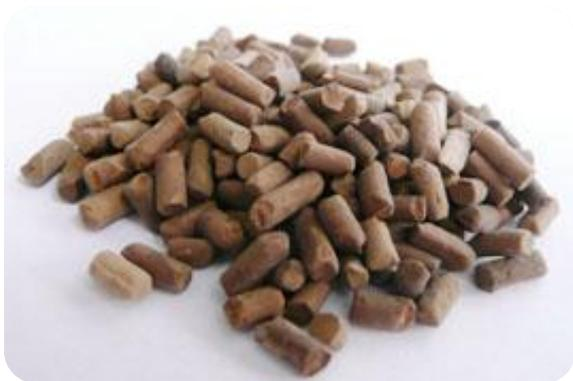
Катализатор АПК используется для очистки от оксидов азота отходящих газов производства азотной кислоты. Носителем для катализатора служат гранулы оксида алюминия. Процесс очистки осуществляется при объемной скорости до 15000-20000 ч<sup>-1</sup>, температуре газовой смеси на входе 400-500°С, на выходе 700-780°С и объемном соотношении метан/кислород равном 0,55-0,60. Остаточное содержание оксидов азота - не более 0,5%.
