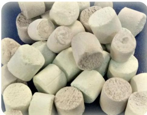
Катализатор защитного слоя (форконтакты) РК-012/014 применяется для использования в процессах гидроочистки средних и тяжелых дистиллятов в дополнении к основному катализатору. Катализатор РК-012 представляет собой активный оксид алюминия, сформованный в виде цилиндров или колец Рашига и содержащий в виде активных компонентов оксид никеля. Используется в качестве катализатора
