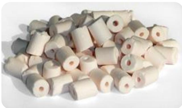
Носитель кольцеобразный корундовый (ГКН-7) используется для производства палладиевого катализатора процесса очистки этилена от ацетилена. Применяют и для нанесения драгоценно содержащих компонентов из числа платины, палладия, родия и серебра.
