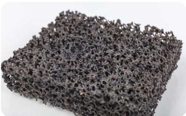
Катализатор ЭКАТ-ЭНДО предназначен для селективной конверсии газообразных углеводородов и аммиака с целью получения атмосфер заданного состава с низким содержанием окислителей. Катализатор применяется для цементации и азотирования различных металлических изделий, а также
