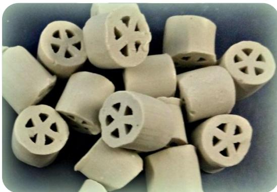
ТК-100, ТК-200 используются в качестве верхнего, удерживающего слоя и распределяющего слоя в реакторах технологических установок нефтепереработки и нефтехимии. Контакт защитного слоя используется в качестве одного из компонентов многослойной системы контактов, загружаемых в реактор с целью сдерживания роста перепада
