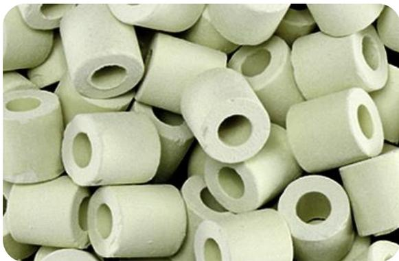
Алюмоникелевый катализатор защитного слоя НК-500 используется в качестве одного из компонентов многослойной системы катализаторов, загружаемых в реактор с целью сдерживания роста перепада давления, предназначен для подготовки сырья гидроочистки бензиновых фракций, селективного гидрирования ненасыщенных структур
