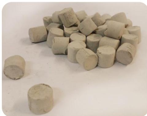
Применяются для автотермической - воздушной конверсии газообразных углеводородов в эндотермических генераторах с контролируемой атмосферой при температурах 800-1050°C, воздушной конверсии сжиженных газов, для парокислородной конверсии под давлением до 3,0 МПа, для вторичного риформинга под давлением до 3,5 МПа, в аммиачных агрегатах производительностью 1360 т/сутки, для первичного риформинга природного газа под давлением 2,5 МПа, для установок металлизации по технологии
