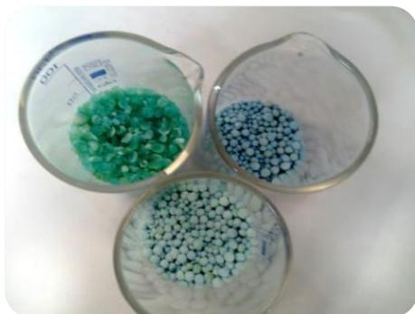
Предназначены для очистки промышленных выбросов от газообразных примесей.
