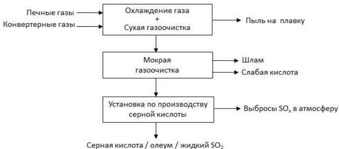
Рисунок 3.2 — Схема очистки отходящих газов плавильной печи и конвертера [18]
