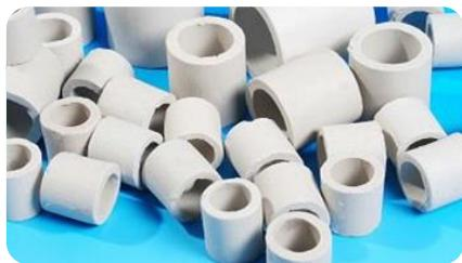
Катализатор защитного слоя (форконтакты) РК-012/014 применяется для использования в процессах гидроочистки средних и тяжелых дистиллятов в дополнении к основному катализатору. Катализатор РК-012 представляет собой активный оксид алюминия, сформованный в виде цилиндров или колец
