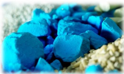
Применяются для гидрирования органических соединений серы в природном газе и нефтепродуктах. Представляют собой формованные гранулы или шарики алюминий содержащего носителя пропитанные растворами солей молибдена и кобальта и термообработанные в воздушной среде. Перед
