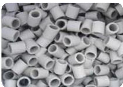
Алюмоникелевый катализатор защитного слоя НК-500 используется в качестве одного из компонентов многослойной системы катализаторов, загружаемых в реактор с целью сдерживания роста перепада давления, предназначен для подготовки сырья гидроочистки бензиновых фракций, селективного гидрирования ненасыщенных структур и деазотирования.
