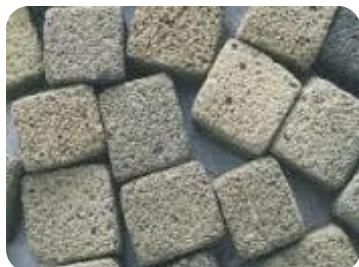
Применяется для воздушной конверсии газообразных углеводородов в эндотермических генераторах контролируемых атмосфер. Используется в различных отраслях, в том числе в машиностроительной промышленности, где контролируемые атмосферы применяются для термообработки металлических изделий и деталей машин.
