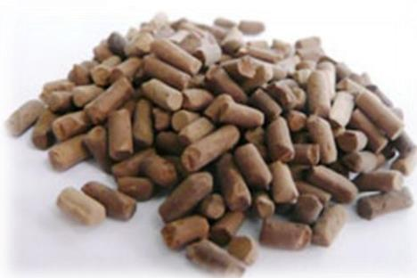
Катализатор алюмопалладиевый используется для очистки от оксидов азота отходящих газов производства азотной кислоты. Носителем для катализатора служат гранулы оксида алюминия. Процесс очистки осуществляется при объемной скорости до 15000-20000 ч<sup>-1</sup>, температуре газовой смеси на входе 400-500°C, на выходе 700-780°C и объемном соотношении
