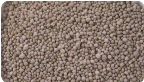
Применяется для тонкой очистки газов и газовых смесей от сернистых соединений. Представляет собой экструдаты цилиндрической формы с развитой пористой структурой. Условия эксплуатации катализатора ГИАП-10-2: температура 350-400 °С, давление 40,0 МПа, объемная скорость 300-500 час<sup>-1</sup>. Условия эксплуатации катализатора ГИАП-10-2а: температура 170-300°С, давление до 4,0 МПа, объемная скорость 500-3000 час<sup>-1</sup>.
