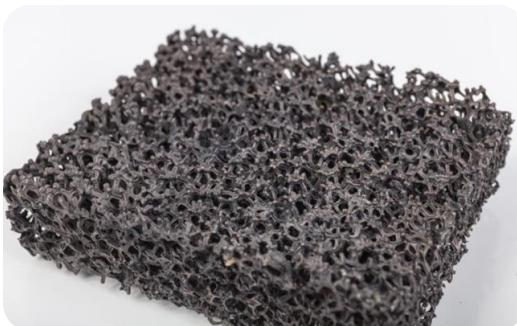
Катализатор ЭКАТ-ЭНДО предназначен для селективной конверсии газообразных углеводородов и аммиака с целью получения атмосфер заданного состава с низким содержанием окислителей. Катализатор применяется для цементации и азотирования различных металлических изделий, а также может быть использован для различной конверсии газообразных углеводородов с целью получения технических газов (синтез-газ, водород).
