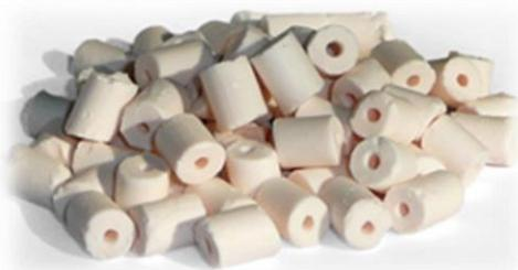
Носитель кольцеобразный корундовый (ГКН-7) используется для производства палладиевого катализатора процесса очистки этилена от ацетилена. Применяют и для нанесения драгоценно содержащих компонентов из числа платины, палладия, родия и серебра. Носитель ГКН-7 выпускается на основе оксида алюминия,
