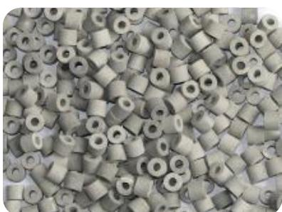
Никелевый катализатор ГИАП-3-6Н используется для паровоздушной конверсии метана во вторичных шахтных конверторах получения синтез-газа, используется в производстве аммиака, метанола. Никелевый катализатор ГИАП-8 используется для паровой, пароуглекислотной, паровоздушной конверсии газообразных углеводородов во вторичном риформинге.
