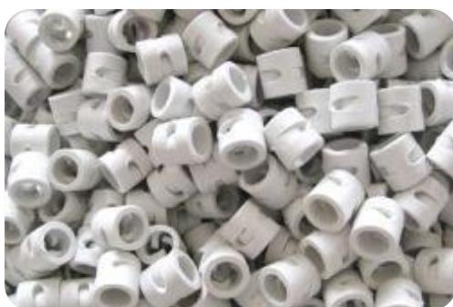
Катализатор верхнего слоя ТНК-2103 используется в реакторах гидроочистки средних и тяжелых нефтяных дистилляторов в дополнении к основному катализатору. Катализатор представляет собой активный оксид алюминия, сформованный в виде колец Рашига, содержащий добавки активных компонентов, способствующих предварительному гидрооблагораживанию сырья и препятствующих образованию коксоотложений.
