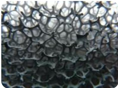
Катализатор ЭКАТ-ЭКО предназначен для глубокого окисления органических соединений до углекислого газа и воды. Катализатор ЭКАТ-ЭКО может быть применим как для существующих реакторов-утилизаторов, так и для проектируемых. Высокая надежность и уникальные свойства катализатора ЭКАТ-ЭКО, делают его незаменимым в области охраны окружающей среды на предприятиях химической, кабельной и нефтехимической промышленности, а так же для процессов утилизации отходов (крематоры, инсинераторы).
