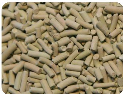
Катализатор РК-500/501/510/520 применяется для использования в процессах гидроочистки средних и тяжелых нефтяных дистиллятов в качестве контактного («подложки») и (или) защитного слоя на различных установках в процессах нефтехимии и нефтепереработки. Катализатор представляет инертный материал, сформованный в виде цилиндра, или цилиндра с одним или несколькими сквозными внутренними каналами, или кольца.
